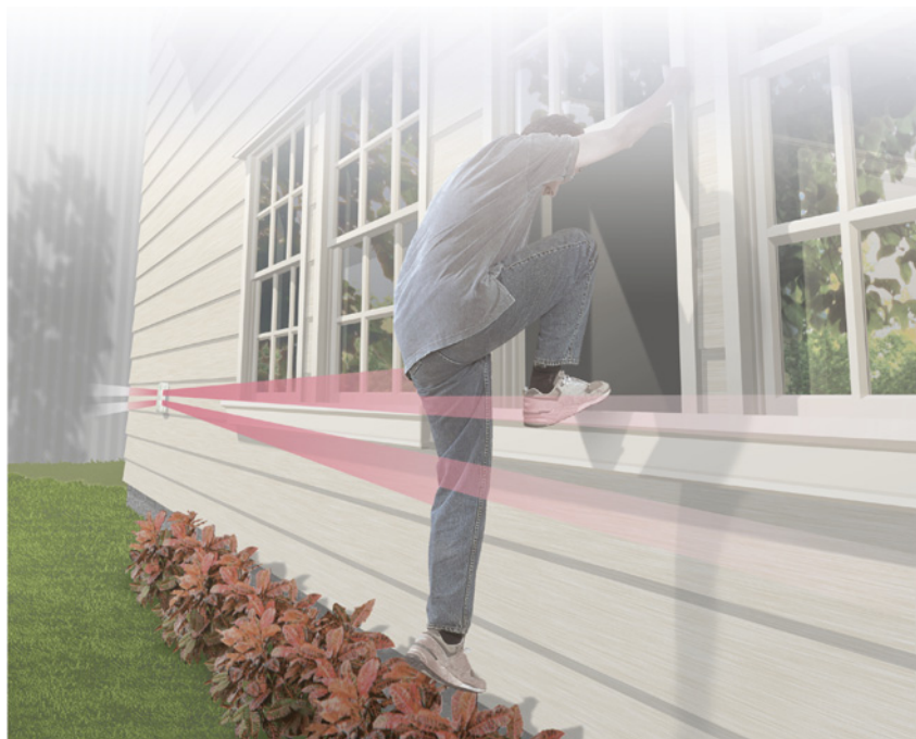
▲ Montowane na posesji i obwodzie budynku bariery mikrofalowe i podczerwieni wysyłają wiązki promieniowania – ich przecięcie uruchamia alarm. OPTEX SECURITY
