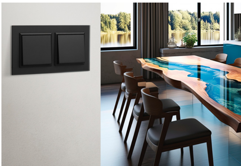
▲ Łączniki powinny być zamontowane tak, aby trafiać na nie intuicyjnie. Przeważnie umieszcza się je wewnątrz pomieszczeń, po tej samej stronie ściany co klamka drzwi, około 90 lub 140 cm nad poziomem podłogi. KONTAKT-SIMON, OSPEL
