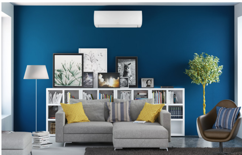
▲ Najlepiej, by jednostka wewnętrzna była umiejscowiona w środku pomieszczenia – pozwoli to zapewnić równomierny rozkład wydobywającego się z niej powietrza. VIESSMANN
