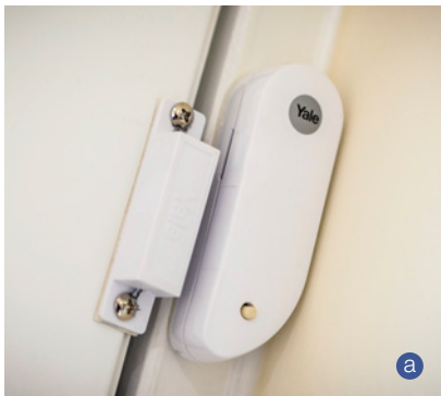
▲ Instalacja inteligentna składa się z sensorów i aktorów. Do tej pierwszej grupy należą m.in. rozmaite czujniki ( a YALE) i klawiatury ( b SOMFY), a do drugiej np. syreny alarmowe ( c J. WERNER).
