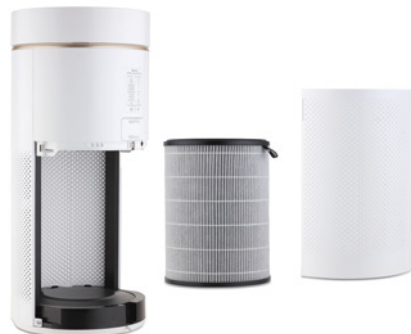
◀ ▲ Oczyszczacz powietrza ze zintegrowanym filtrem kompozytowym, składającym się z 4 warstw – filtr wstępny usuwa duże cząstki stałe (kurz, pyły i sierść zwierząt); aktywny filtr węglowy neutralizuje toksyczny formaldehyd; kompozytowy HEPA zatrzymuje zanieczyszczenia, bakterie, pyłki (w tym PM 2,5), dym tytoniowy oraz roztocza.
